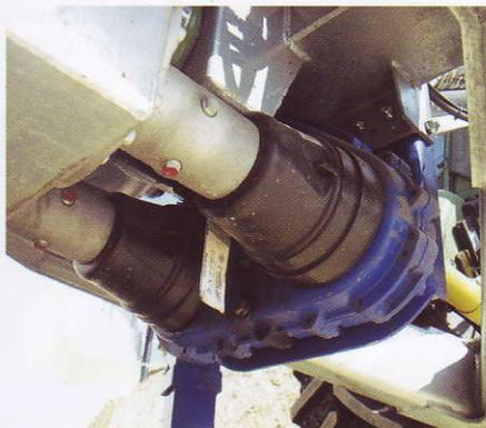
Die Doppelpumpe kann komfortabel zugeschaltet werden: zwei Pumpen zum Ansaugen, eine zum Ausbringen.
