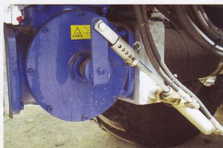
**Mit dem Schieber kann zwischen Umpumpen und Ausbringen über die Schleppschläuche umgeschaltet werden.**
