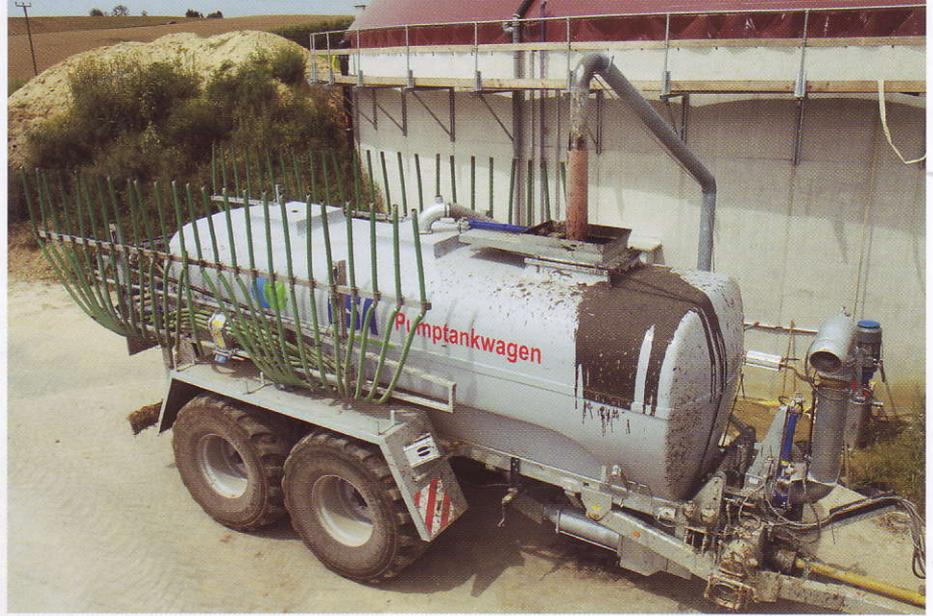
Angenehm ist der Schiebedeckel zum Befüllen mit einer externen Pumpe aus einem Hochbehälter. In drei Minuten war das Fass voll.
