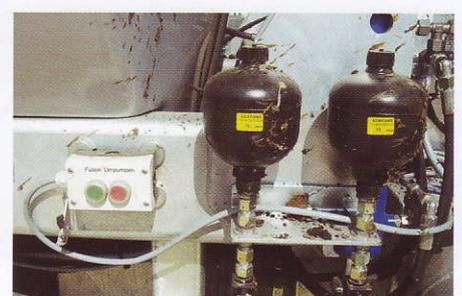
Zwei Federspeicher dämpfen die Schläge der Deichsel. Das funktioniert gut und sorgt für Fahrkomfort.
