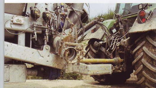
Die Untenanhängung mit einer 80-Kugelkopf-Kupplung und höhenverstellbarer, gefederter Deichsel gefällt.
