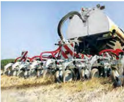
**XTill** bedeutet bodenschonende, streifenförmige Bodenbearbeitung im Strip-Till-Verfahren – mit optionaler Gülleunterfußdüngung. Gülle kann parallel ausgebracht werden und wird emissionsarm genau dort abgelegt, wo die Pflanzen die Nährstoffe benötigen: im Wurzelbereich. Die Parallelogrammbauweise sorgt für eine gleich bleibende Bearbeitungstiefe. Über ein in der Höhe verstellbares Lockerungsschar wird die Gülle in gewünschter Tiefe unter Fuß im Depot abgelegt.
