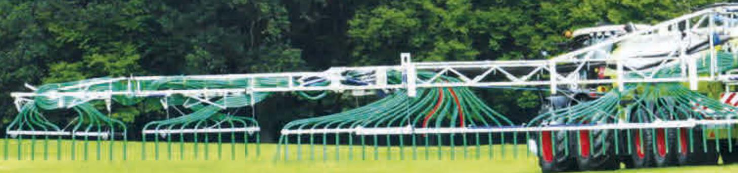
SwingMax36 ist eine Konstruktion auf Basis des bewährten SwingMax3-Schleppschlauchgestänges. Der Rahmen wurde aufgrund der enormen Arbeitsbreite dreifach aufgebaut und ein zusätzliches Klappenelement hinzugefügt. Für eine präzise Ausbringung sorgen drei ExaCut-Exaktverteiler.
